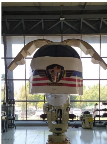
Imagen 3 entrenador de vuelo robótico completo modelo cessna Fuente: propia
